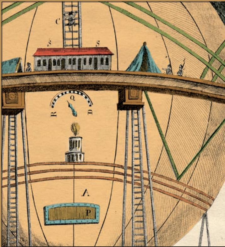
**C** Seidene Strickleitern um zu allen Theilen der Kugel kommen zu können. **S** Der Studiersaal, das physikalische und naturhistorische Kabinet. **Q** Ein Weiser, welcher die Ausdehnung [D] und die Verdünnung [R] des Gases im Ball anzeigen. **A** Große Kugel von 132 Fuß im Durchmesser, aus gefirnistem, eigends dazu in Lhon verfertigen Tafft. **P** Die Klappe, oder das Ventil.
